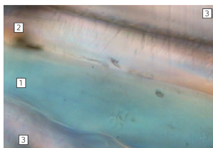
➤ Řez chemo-optickým převodníkem tvořeným PDMS matricí funkcionalizovanou organo-metalickým reagentem 1 – vrstva převodníku, 2 – sekundární polymerní obal, 3 – epoxidová pryskyřice
