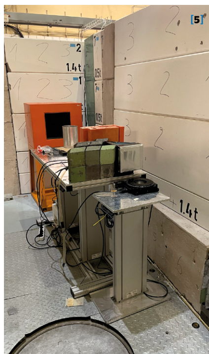
↙ [1][2] Měření neutronové tomografie buddhistických sošek pro Národní galerii Praha [3][4] Kulka, která je spojována s vraždou kněžny Windischgrätzové, a její 3D rekonstrukce, provedená pomocí neutronové tomografie s označenými úlomky kostí [5] Zařízení pro neutronové zobrazování TRIXIE
