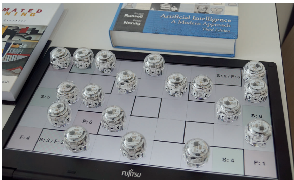
Testování vykonávání diskretních plánů se skutečnými roboty OzobotEVO (foto: Pavel Surynek)
