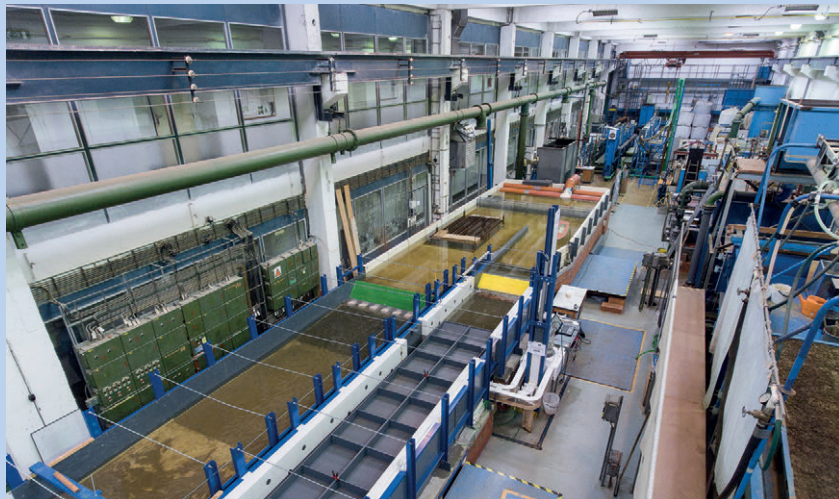
➤ Ve Vodohospodářském experimentálním centru FSv byl ověřen hydraulický model plánované plavební komory Děčín na dolním Labi.
